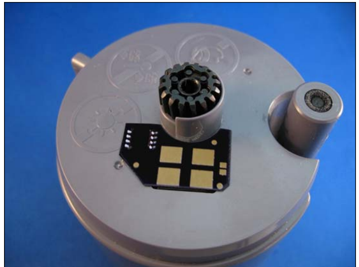
15. Pegar el nuevo chip en la posición que se muestra.
