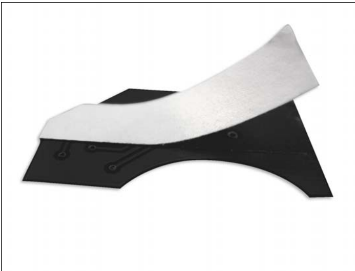
14. Retirar el papel del adhesivo del nuevo chip.
