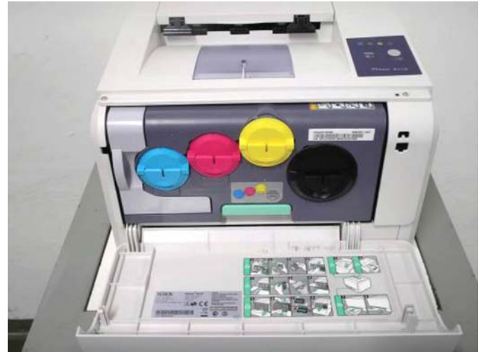
Impresora Color Xerox Phaser 6110 cerrada y abierta mostrando sus cartuchos de toner en posición de trabajo y los chips de reemplazo.
